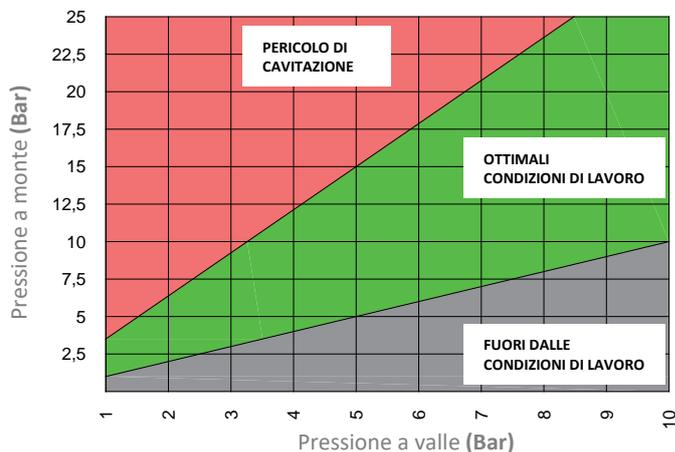
Quando il rapporto tra la pressione a monte e la pressione a valle supera il valore 3:1 si ha un funzionamento in cavitazione del componente, è dunque necessario prevedere due riduttori di pressione installati l'uno dopo l'altro, in modo da eseguire una RIDUZIONE DI PRIMO LIVELLO e successivamente una RIDUZIONE DI SECONDO LIVELLO.
