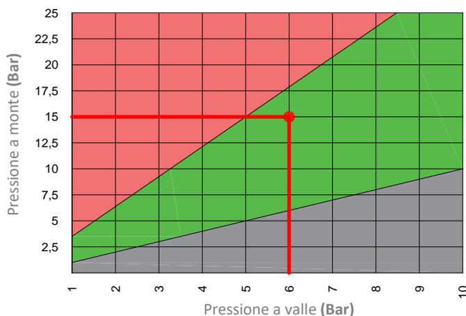
Mediante il secondo riduttore la pressione verrà abbassata da 6 bar a 3 bar, con il rapporto ottimale  $6:3 = 2$  (RIDUZIONE DI SECONDO LIVELLO).
