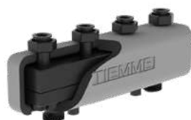
5539X Separatore idraulico/collettore in acciaio con coibentazione e staffe di fissaggio, interasse circuiti 125 mm, attacchi con sede piana e calotta 1"1/2
