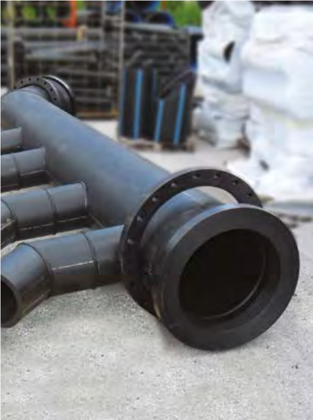
Collettore Ø560 PN10 SDR17 PE100 13105 Mimet (Francia)
