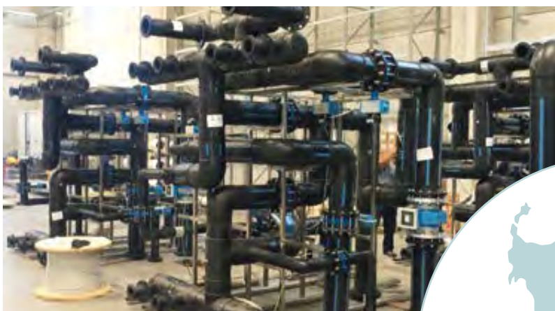
Collettore Ø125 PN16 SDR11 PE100 - Macchiareddu (CA)
