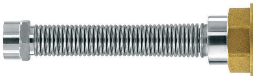
Le norme di installazione UNI 7129, UNI 11528 e UNI 8723 prevedono che il collegamento tra l'impianto gas interno ed il gruppo di misura (contatore del gas) debba essere realizzato evitando sollecitazioni (possibili nel caso si utilizzino tubi metallici rigidi come ad esempio in rame o acciaio zincato) sul gruppo di misura utilizzando, ad esempio, giunti elastici installati immediatamente a valle del punto di inizio.
