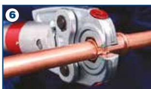
6 Allineamento delle ganasce al raccordo
