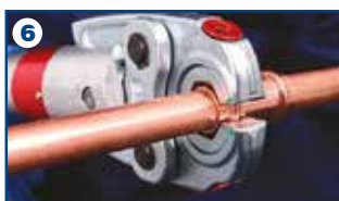
6 Allineamento delle ganasce al raccordo
