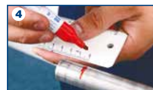
Marcatura profondità di giunzione
