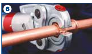
6 Allineamento delle ganasce al raccordo
