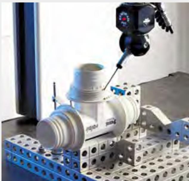
Bravopress® è un sistema di raccorderia che alle eccezionali caratteristiche meccaniche del polifenilsulfone unisce i vantaggi di una giunzione mediante pressatura della boccola in acciaio.
