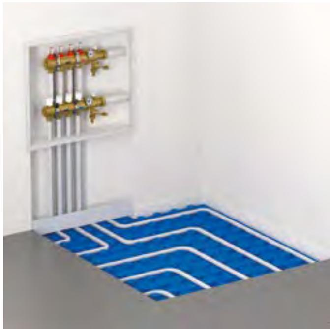
Impianto radiante realizzato con tubo multistrato Pexal
