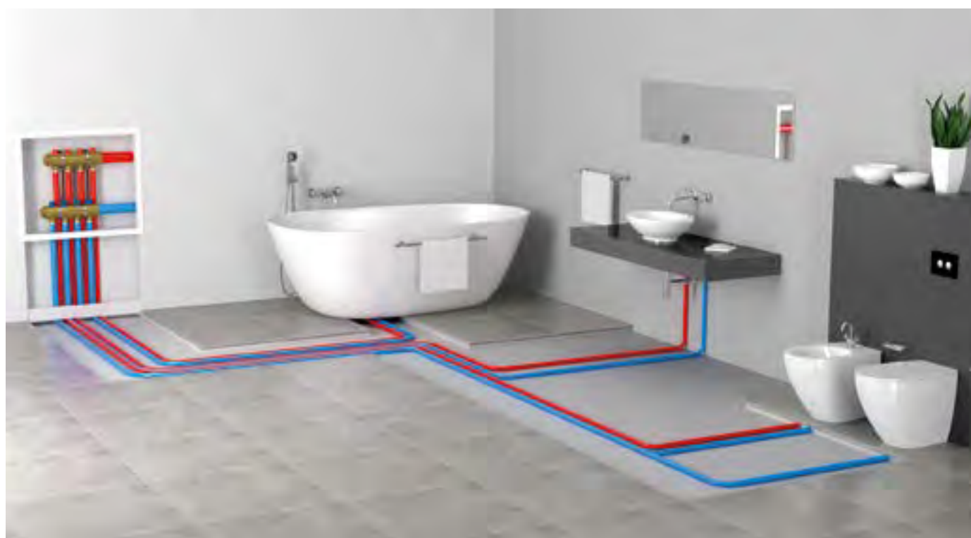
Impianto sanitario realizzato con tubo multistrato Mixal preisolato o con guaina corrugata protettiva colorata
